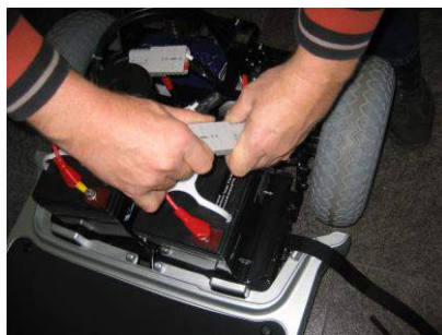
Abb. 29 – Batteriestecker 2 mal ziehen
