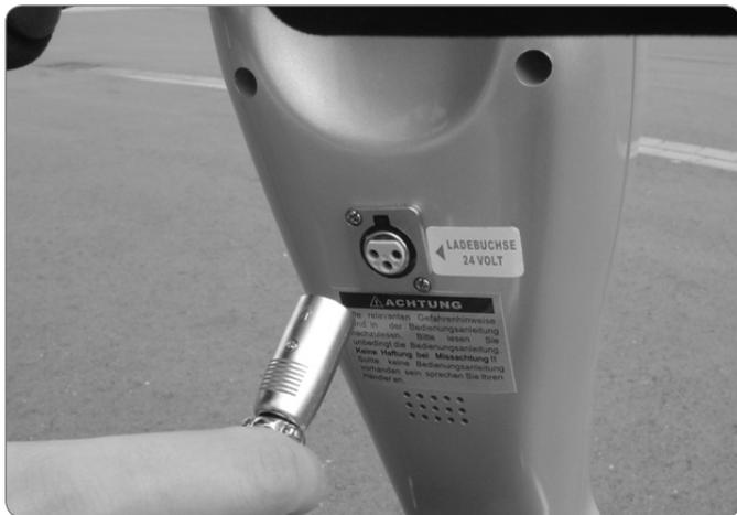
Die Batterien des Elektromobils müssen nach jeder Fahrt wieder aufgeladen werden. Sie können die Restladung der Batterien an dem Leuchtband auf der Konsole des Elektromobils ablesen. Dabei bedeutet:
