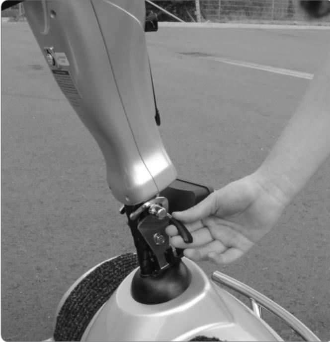
Die Lenksäule Ihres Elektromobils ist so entwickelt, dass sie Ihnen erlaubt, sie in eine bequeme Fahrposition zu bringen. Sie kann in verschiedenen Positionen festgestellt oder auch für Transportzwecke gelöst werden, damit sie frei beweglich ist. Die Lenk-
