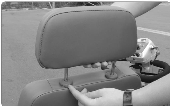
Die Kopfstütze Ihres Sitzes kann durch Betätigung der kleinen Klinke, die sich am Sockel der linken Stützstange befindet, in der Höhe verstellt werden. Ziehen Sie die Kopfstütze hoch oder drücken Sie sie runter in die für Sie bequemste Position. Aus praktischen Gründen kann die Kopfstütze auch herausgezogen werden.
