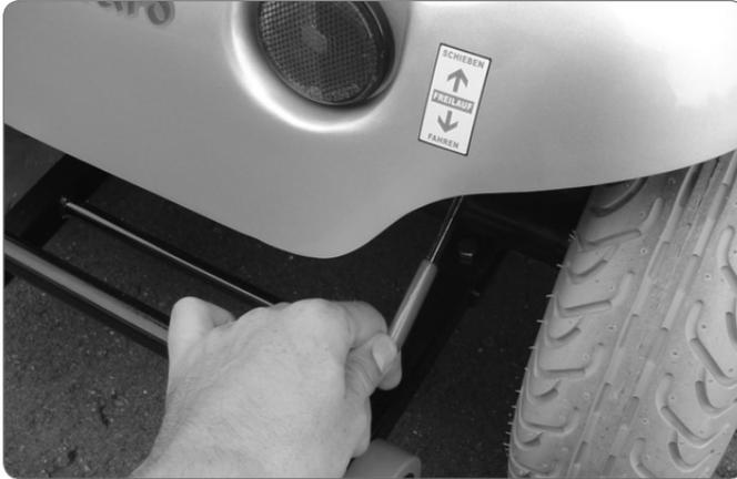
Der Freilauf sollte nur eingelegt werden, wenn Sie Ihr Elektromobil von Hand schieben müssen. Durch Einlegen des Freilaufs wird der Antrieb von den Rädern abgekoppelt und ihr Elektromobil kann frei rollen.
