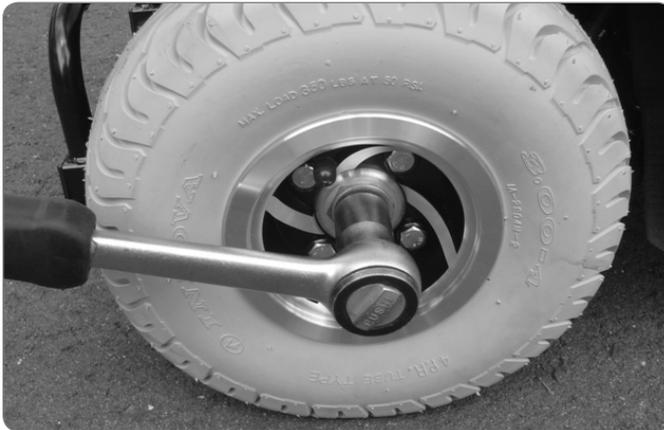
1. Um ein Rad von Ihrem Elektromobil abzumontieren, entfernen Sie zuerst die Radmutter.
