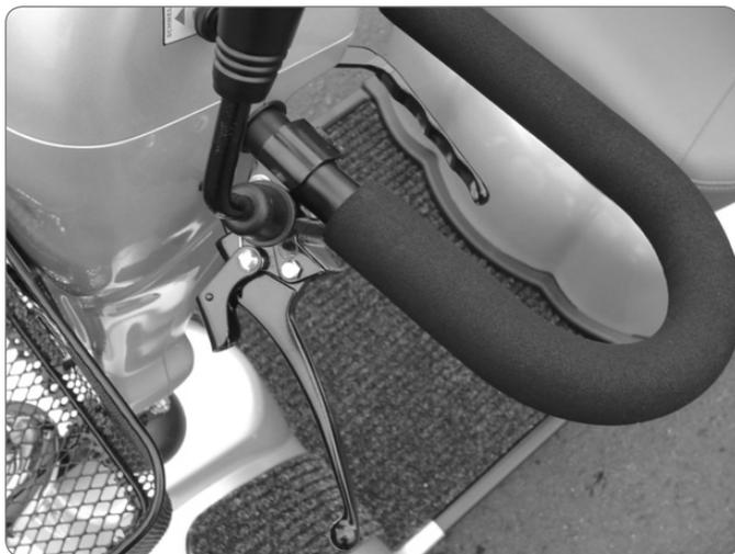
An der linken Seite des Lenkers befindet sich der Hebel für die Handbremse. Durch Zug an diesem Hebel werden die Trommel-
