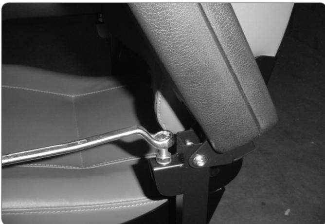
Die Winkel der Armlehnen können ganz nach Ihren Bedürfnissen angepasst werden. Für die Einstellung der Armlehnenwinkel benötigen Sie zwei 13 mm-Schraubenschlüssel (nicht im Lieferumfang enthalten). Heben Sie die Armlehne an, und Sie
