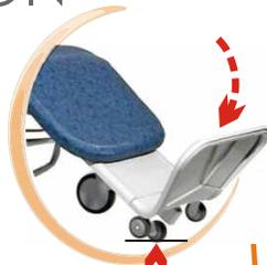
Beim Übergang von der Liege- in die Sitzposition wird die Fußstütze (unabhängig davon, in welcher Position sie sich befindet) eingezogen und klappt sich automatisch auf, wenn die Rolle den Boden berührt.
