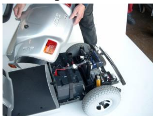
Abb. 31 – Kunststoffhaube über Batterien
