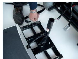
Abb. 37 – Stifte wieder in Bohrungen stecken
